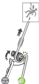
Debido a una caída o al reposo del escalador, la cuerda se tensa, la leva pivota y pinza la cuerda para bloquearla.
